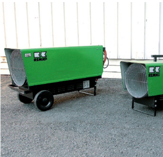
Suorapolttotyyppisten nestekaasulämmittimien teho vaihtelee noin 10 kW:sta yli 100 kW:iin.
