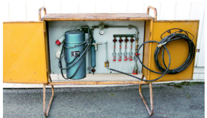
Höyrystin, nestekaasun syöttökapasiteetti 32 kg/h. Mitat (L x K x S) noin 80 x 111 x 40 cm. Teho 6 kW, jännite 400 V.
