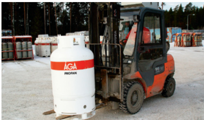
184 kg:n maksipullo nestekaasua. Pullossa on erilliset lähtöliitännät kaasulle ja nesteelle.
